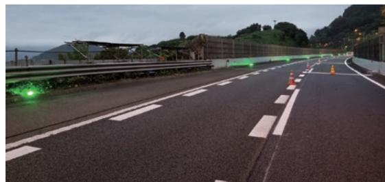
ミチテラは、GARASU LIGHTやアミューズメントパークでの演出など、LEDを利用した製品開発や技術を結集し、安全に車両・人を誘導します。路面に容易に設置でき、各灯具を発光・発色制御することによってスムーズに、より安全に車や人の流動を制御することができます。
