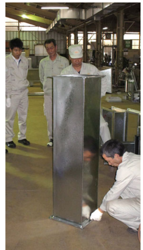
手作業によるフランジ部製作
