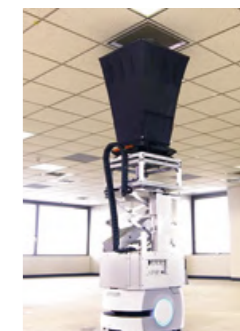
自律走行型ロボットによる風量測定
