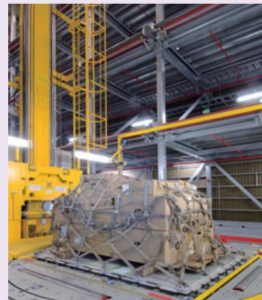
ETV (Elevating Transfer Vehicle) によるカーゴの移送
