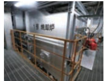
▲水冷ストーカ式焼却炉
