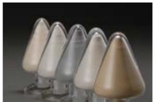
石油精製触媒（流動接触分解（FCC）触媒）
