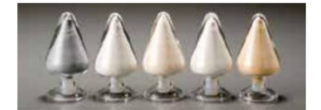
石油精製触媒(流動接触分解(FCC)触媒)
