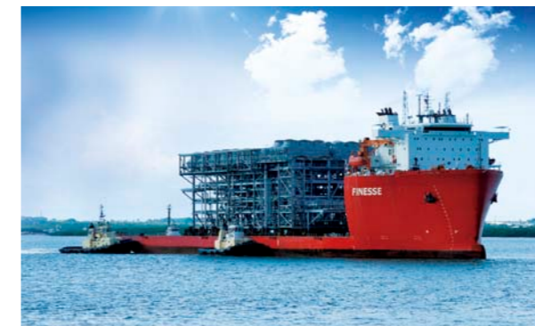
総重量5,000トン超のモジュールの輸送
