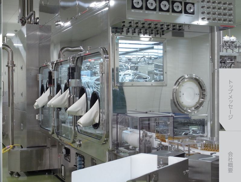
無菌製剤の充填工程のアイソレーター
