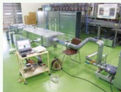
薄板ダクトの性能評価試験状況
