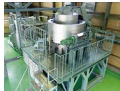
国内最大規模の超臨界CO 2 洗浄再生装置
