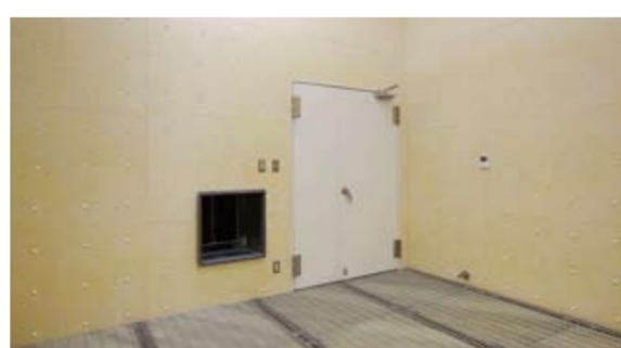
空調設備などから発生する騒音の検証実験を行うための音響実験室です。吹出騒音などの検証ができるよう、無音送風装置を備えています。
