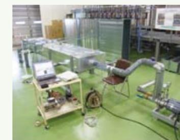
薄板ダクトの性能評価試験状況
