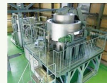
国内最大規模の超臨界CO<sub>2</sub>洗浄再生装置
