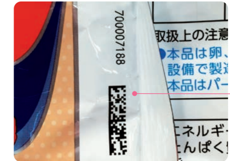
作業ミス防止照合システムで読み取るフィルムに記載されているコード
