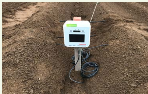
圃場に設置した土壌水分計の端末
