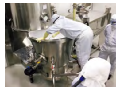
新工場ユニット7で、造粒した原薬を取り出している現地スタッフ
