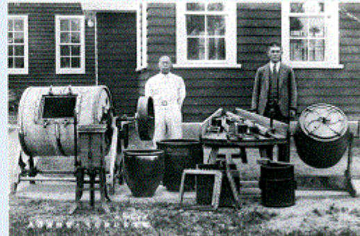
設立当時に使用されたバター製造機器
