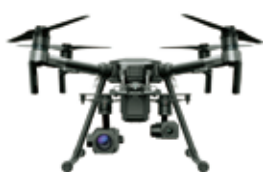
赤外線カメラを搭載した点検用ドローン
