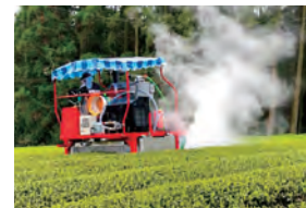
農薬を使用せずに防除や除草ができる「蒸気防除・除草機」などを開発し、減農薬、有機栽培を推進
