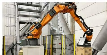
ケース品をコンベヤに投入するアーム型ロボット。従業員の作業負担低減に貢献している。
