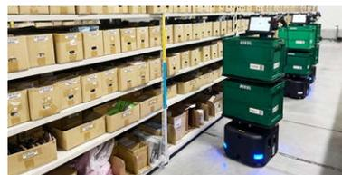
ピッキング作業の歩行工程の大幅削減を実現し、生産性を向上している。
