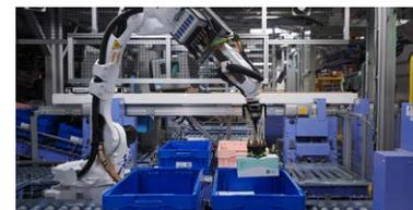
3次元画像認識を行い、動作計画を自動生成するアーム型ロボット。2,000種類の商品の把捉が可能。
