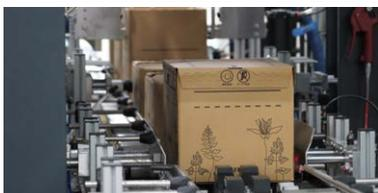
箱の大きさを最小化するため、ダンボール内の商品高に応じて上部を折り畳み、蓋をする梱包機。
