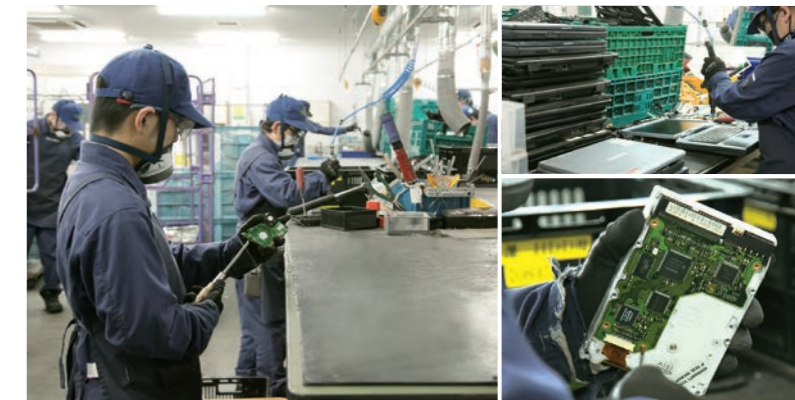
エアコンなどの配管から銅を、情報機器の基盤などから金・銀を主に回収しています
