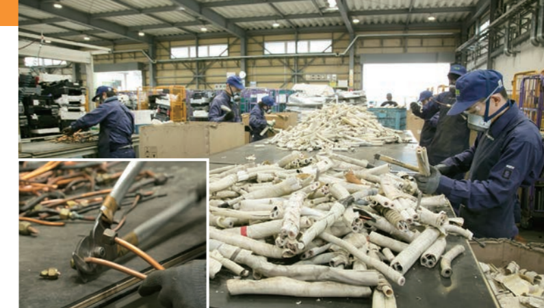
エアコンなどの配管から銅を、情報機器の基盤などから金・銀を主に回収しています
