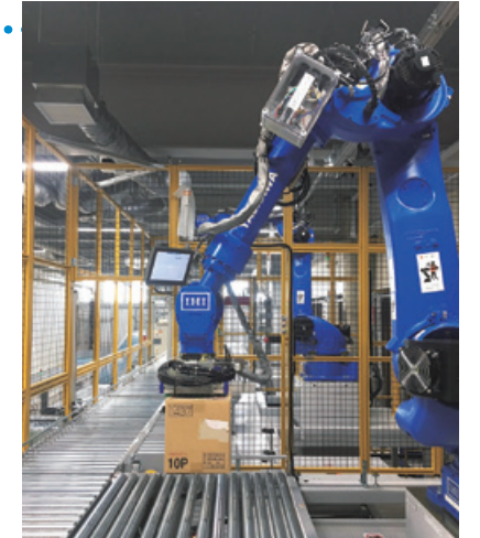
AIデパレタイズロボット： 2基で毎時間900ケースを出庫可能
