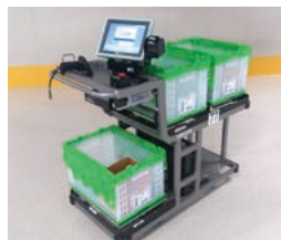
②AiMAS 全国2,525台導入の重量検品 機能付ピッキングカート
