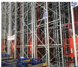
①パレット自動倉庫 高・中・低の棚段設定で 効率的な格納を実現
