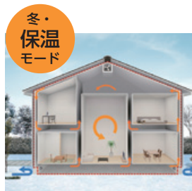
外断熱・二重通気工法
