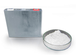
ニオブを負極材に用いた次世代リチウムイオン電池
