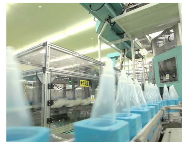
プラスチックカップでボトルを運ぶ従来型のマヨネーズ生産ライン
