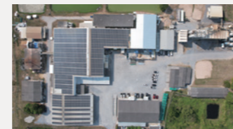
ティムフード社(タイ) 2021年4月導入。全発電量の約18%を補うことができる。(CO 2 削減量は約760t-CO 2 /年)
