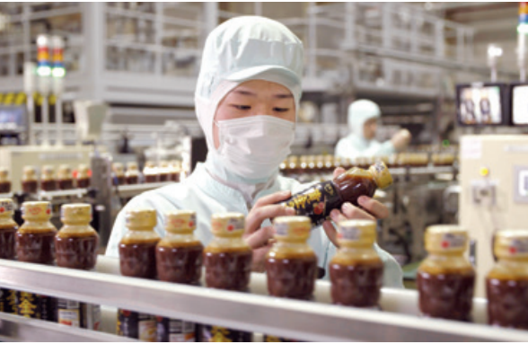
製品の外観確認
