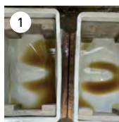
1 前工程で使用した防錆油が箱の底に溜まっている様子
