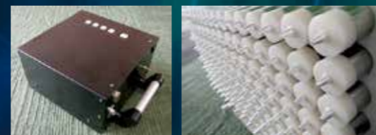
左：超音波アレイセンサー外観 右：超音波プローブ(コンクリート接地面)
