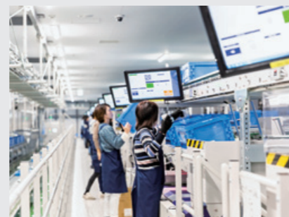
作業プロセスの効率化を図り、出荷制度とスピードを向上させる定点ピッキングステーション
