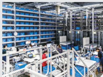
異なる保管エリアから出庫した商品をスピーディーに配送単位に集約する名寄せステーション
