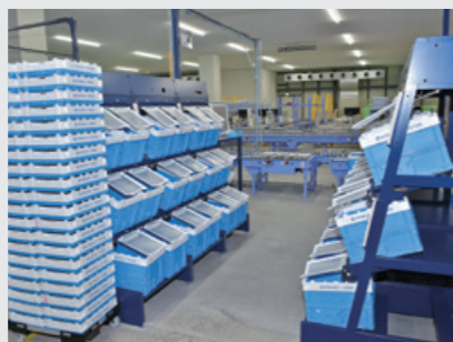
ピッキングした商品を仕分けるゲート・アソート・システム
