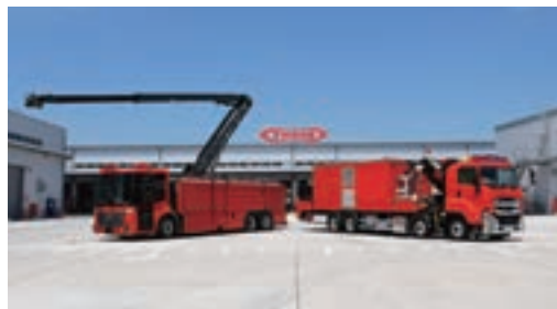
コンビナート用オールインワン型消防車と大型化学車
