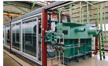
イオン交換膜法食塩電解プロセス
