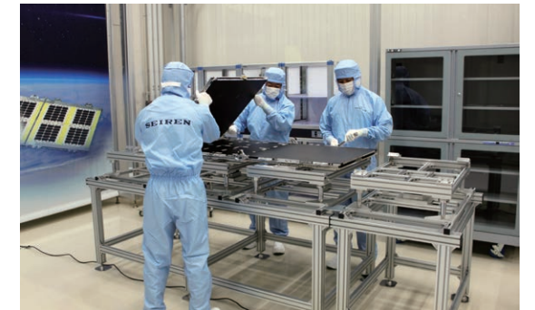
衛星アンテナ組み立て作業の様子
