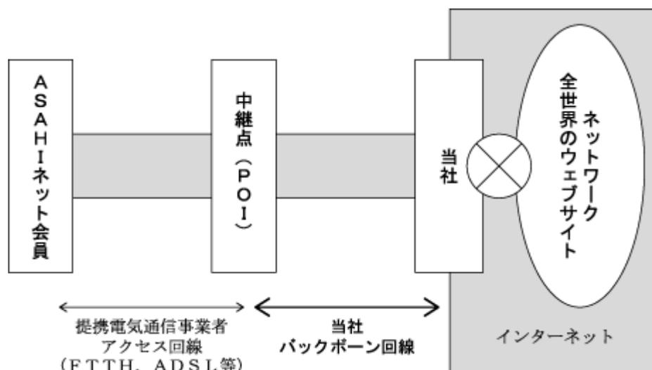
ASAHIネット会員にインターネット接続環境を提供するために、当社はインターネットを構成する一員として全世界のサイトやネットワークと相互接続ができる通信環境を構築しております。インターネット接続環境の提供にあたっては、全国の中継点(POI: Point Of Interface、相互接続点。NTTの局舎などに設置される)の間にバックボーン回線を構築しております。
