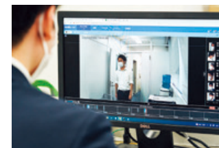
AIカメラでサーバールーム等の入退室を監視 (登録されていない人物を認識すると担当者にLINEで通知)
