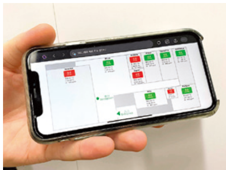
オフィスの状況(温度、湿度、CO 2 濃度、在室状況)を社員のスマートフォンから確認する様子
