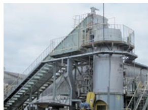
難処理古紙溶解設備 ニーディング バルバー (王子マテリア富士工場)
