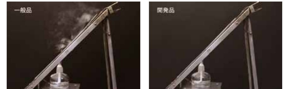
アルコールランプ加熱による発煙性テスト
