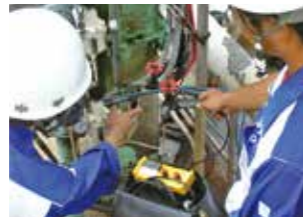
王子製紙春井工場での省エネパトロール エア漏れによる無駄がないかの確認
