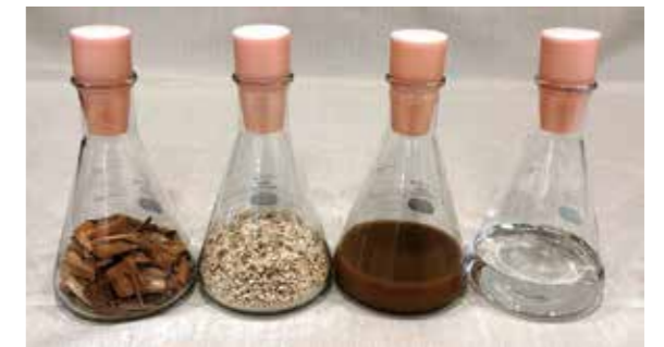
バイオエタノール製造過程(左から、チップ、パルプ、糖化発酵培養液、バイオエタノール)
