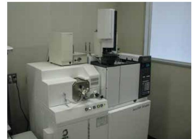
ガスクロマトグラフ飛行時間型質量分析計
