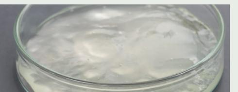
当社が開発し2018年に発表したセルロースナノファイバーで、木材からセロファンをつくる製造工程の中間生成物を微細化した繊維状物質です。一般的にセルロースナノファイバーは鉄鋼の5分の1の軽さで5倍の強度を有するといわれ、次世代素材として産業界で大きな注目を集めています。RCNFは繊維径が細く緻密なネットワークを形成することが可能で、かつ熱安定性が高いことが特長です。樹脂材料と複合させることで樹脂の強度向上や
