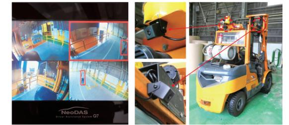
AIカメラによる車両との接触防止
