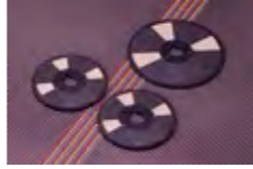
異方導電という画期的な特性を持つ回路接続フィルムを開発。高画質な液晶画面の大量生産を実現
