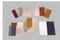
複雑な配線を1枚の銅張積層板に集約成功。電子回路の大量生産でテレビやラジオの普及に貢献
