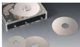
記憶容量の増加ニーズの流れを見据え、スパッタリング(薄膜形成技術)によるハードディスクメディア製造に挑む
