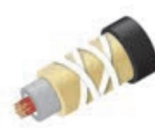
アクアキープ®は、電力・通信ケーブル用止水材にも使用されています。これはアクアキープ®の「瞬時に吸水して膨らむ」という機能によってケーブルの被膜剤が損傷を受けた際に、ケーブル内部への水の浸入を防ぐことができるためです。世界トップクラスの吸水速度を持つアクアキープ®シリーズは、付加価値の高いケーブルの止水材に使用され、高い評価を受けています。
