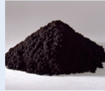
リチウムイオンバッテリー向け導電助剤 (アセチレンブラック)
