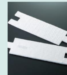
自動車分野で活躍するFLECSシリーズ<sup>®</sup>は、環境改善を目的とした自動車の排気管部品(触媒担体やDPF)において、高い保持性やシール性、断熱性を発揮するセラミック繊維(アルミナファイバー)を活用した高品質の製品です。\* FLECS: FLExible Ceramic Sheet の略
