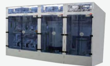
※半導体のCMP（研磨）工程化学品の液種に応じた、濃度や粒子径を均一化し、安定的かつ高精度に調合できる設備。米国企業との提携による基本技術をもとに、2006年より当社グループが国内の半導体工場向けに最適な供給システムとして設計・製造しており、多数の実績を有しています。
