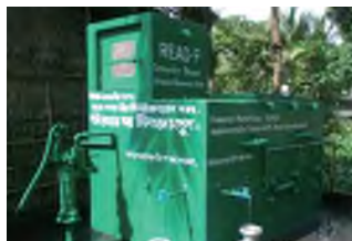
リード吸着剤を使用したヒ素除去装置
