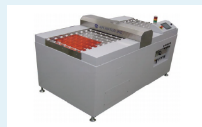
搬送機付リモート型大気圧プラズマ装置
