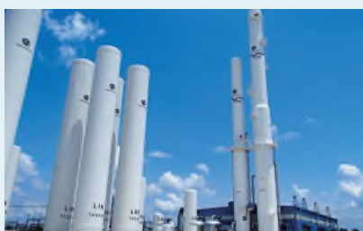
アルゴン併産型の高効率小型液化酸素・窒素製造装置「VSUA」
