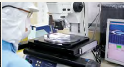
顕微鏡による針先の検査工程
