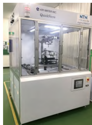
「QuickSnow」 ドライ洗浄装置
