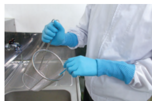
調理器具の微生物付 着検査のための拭取り サンプリング作業
